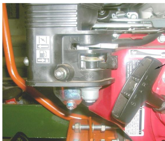
Рисунок 8. Запуск двигателя при помощи рукоятки стартера
